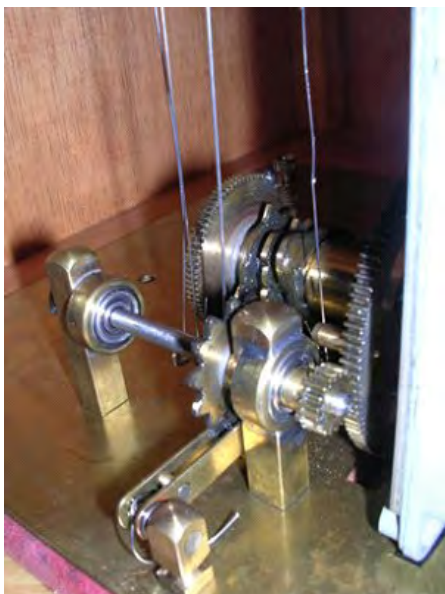
FIGURA 9. Detall dels mecanismes de funcionament de l'autòmat Pallasso mandolinista (1880), de Gustave Vichy. FONT: Arxiu tècnic de Lluís Ribas Duran.
