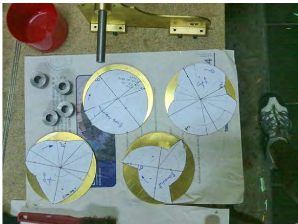
FIGURA 22. Diagrames de laves, fets en paper, com a plantilla per a retallar les peces de llautó que serviran de laves. Dibuixos de petits mecanismes i càlculs de recorreguts, de distàncies, de gruixos, etcètera, formen l'univers diari de la construcció i la conservació dels autòmats. FONT: Arxiu tècnic de Lluís Ribas Duran.
