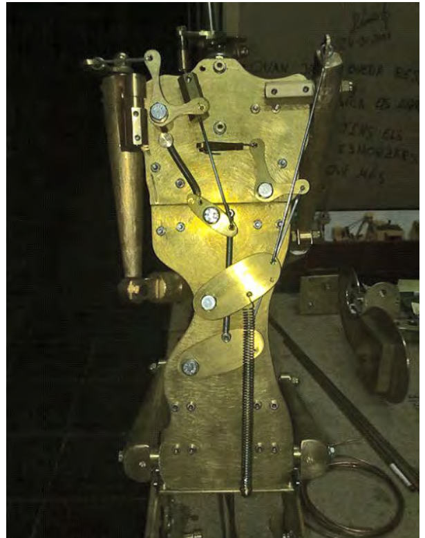
FIGURA 18. Part del darrere d'un autòmat construït per l'autor de l'article. S'hi poden veure les palanques d'acurada execució on arribaran els cables, varetes o fils per estirar-les. FONT: Arxiu tècnic de Lluís Ribas Duran.
