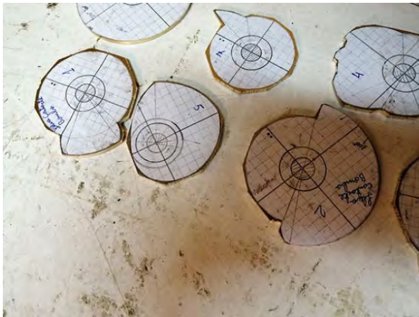
FIGURA 17. Plantilles en paper dels dissenys de les lleves enganxades sobre el material amb què es construiran. Fixem-nos en els infinits perfils que poden tenir. Cada perfil farà executar un moviment a les extremitats, de manera coordinada amb tot el conjunt. FONT: Arxiu tècnic de Lluís Ribas Duran.
