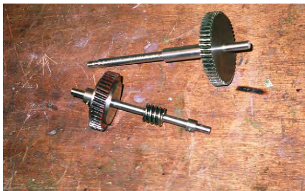
FIGURA 14. Conjunt dels dos arbres, un dels quals amb un vis sens fi, i els dos engranatges.
